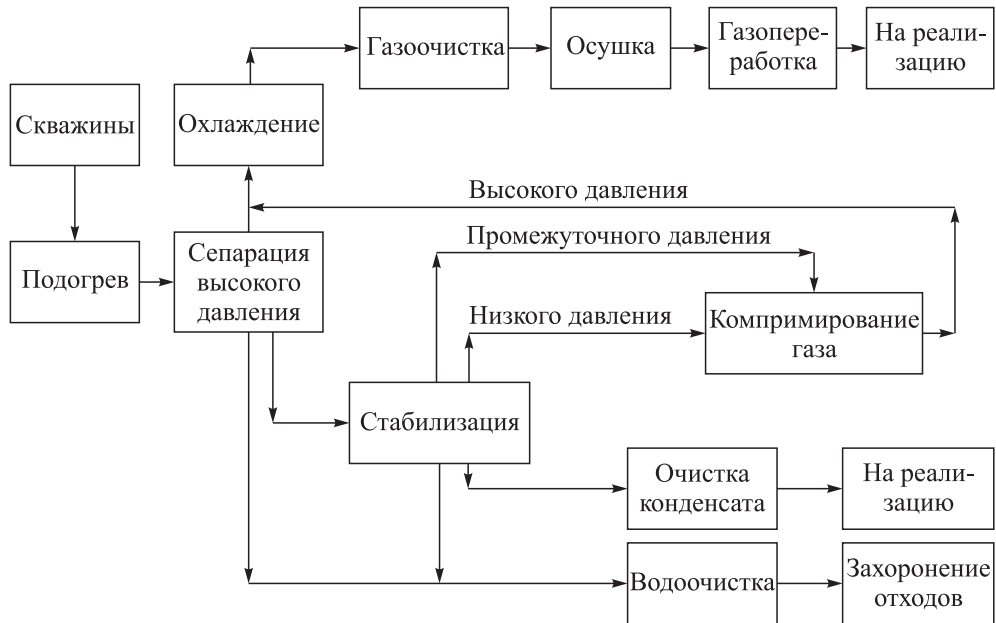
Рис. 1.3. Типовая установка комплексной подготовки газа
