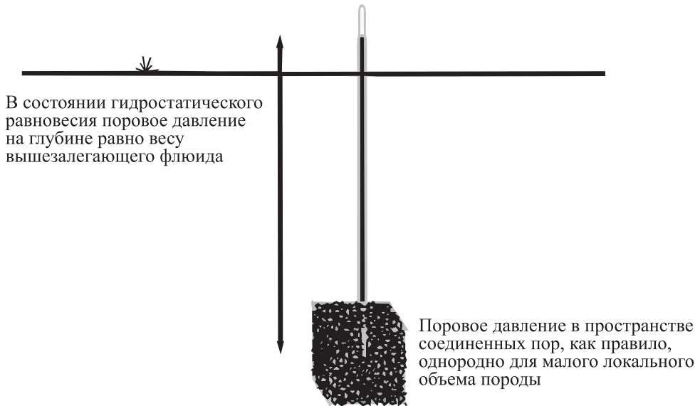
Рис. 1.5. Поровое давление в проницаемой породе под действием гидростатического давления (по материалам GeoMechanics Intl. Inc. )
